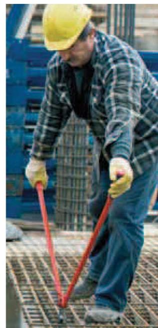
La speciale forma del tagliabulloni 71 82 950 permette di tagliare reti elettrosaldate per cemento
