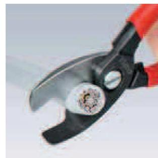
**Taglio di finitura:** per facilitare il taglio, dopo aver tagliato la guaina del cavo sul profilo anteriore, vengono tagliati i conduttori sul profilo posteriore. Primo taglio in posizione anteriore, taglio di finitura in posizione posteriore.
