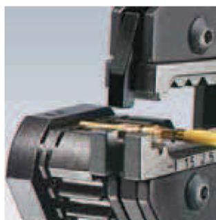
97 43 200 con matrice di crimpaggio 97 49 61 e ausilio di posizionamento 97 49 90 per connettori torniti con diversi diametri del corpo, orientabile
