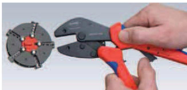
Posizionare e sostituire: azionare la leva di posizionamento per fissare le ganasce in parallelo
