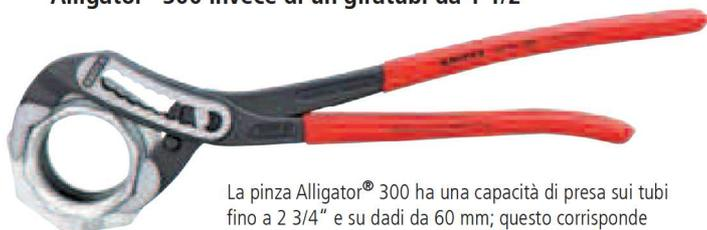
La pinza Alligator® 300 ha una capacità di presa sui tubi fino a 2 3/4" e su dadi da 60 mm; questo corrisponde alla capacità di presa di un giratubi da 1 1/2" che però è più grossa e pesa di più.
