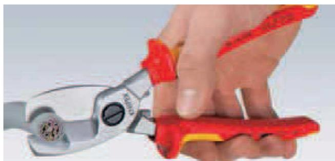
**Primo taglio:** Utilizzando i taglienti anteriori per il taglio della guaina isolante, resta garantita una presa ergonomica anche in caso di cavi di grosso diametro.
