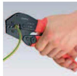
Fase 3: Se è necessario applicare molta forza, p. es. per i connettori isolati di 6 mm<sup>2</sup>, la lunghezza dei manici permette un azionamento a due mani
