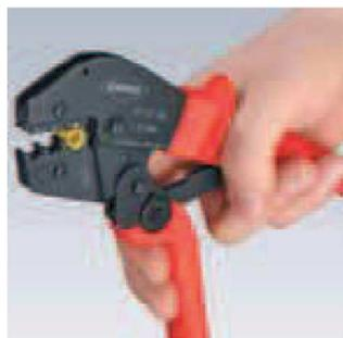
Fase 1: Chiudere la leva del manico con due dita fino a quando entrambe le ganasce poggiano sul connettore da serrare
