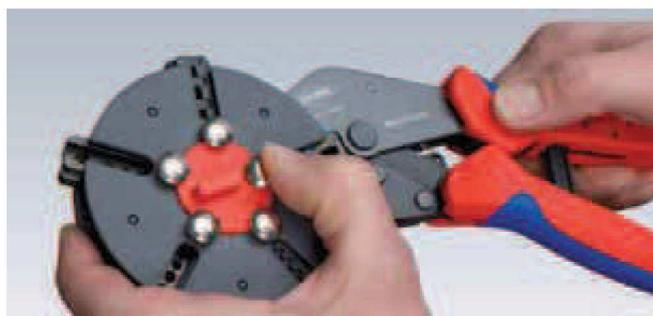
Sostituzione matrice di crimpaggio: sbloccare il fermo della matrice sul supporto e successivamente rimuovere la matrice
