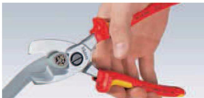
**Taglio di finitura:** per facilitare il taglio, dopo aver tagliato la guaina del cavo sul profilo anteriore, vengono tagliati i conduttori sul profilo posteriore. Primo taglio in posizione anteriore, taglio di finitura in posizione posteriore.
