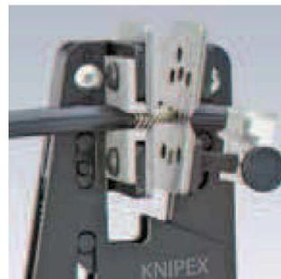
Rimozione automatica dell'isolamento
