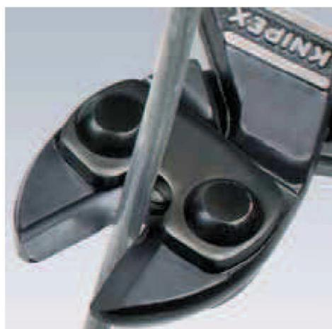
71 31/32/41 200: l'incavo del tagliente presso l'articolazione permette di serrare i fili di maggior spessore in una efficace posizione di taglio (rapporto di trasmissione ottimizzato). Niente più riposizionamento come solitamente necessario con i tronchesi a doppia leva.
