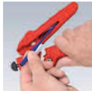
Con l'utensile di montaggio sono forniti tre punzoni Torpedo per le diverse sezioni di cavo
