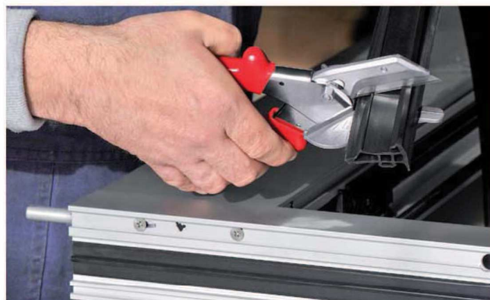
Intagliare e rompere il truciolo in un'unica operazione
