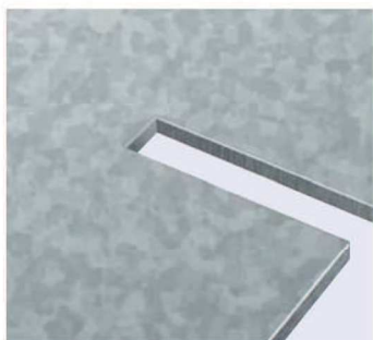
Intagliare e rompere il truciolo in un'unica operazione
